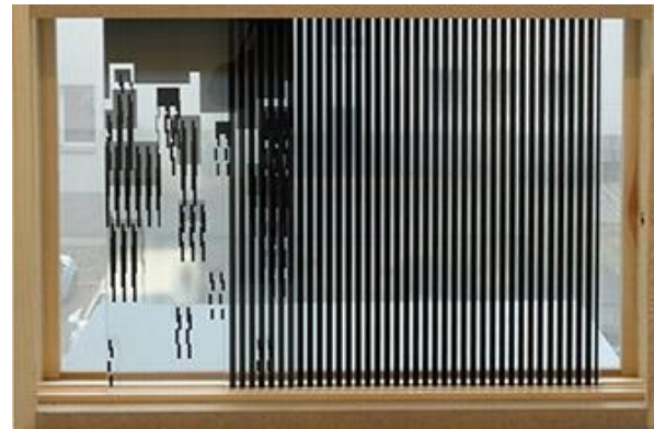
شكل (3) يوضح فكرة عمل المربعات المتحركة، الإعتام في الصورة العلوية و شبه شفافية في الصورة السفلية.
